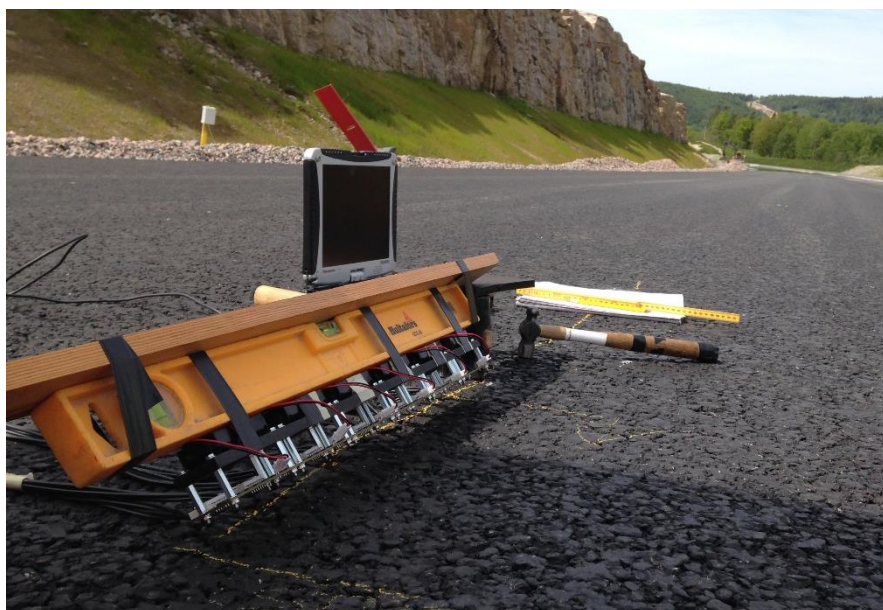
Figur 29. Mätupställning från MASW mätningar längs provsträckan på riksväg 40
